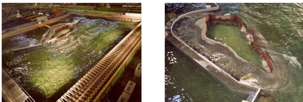
Figura 29. Ensayo en modelo físico 3D Dique Perimetral del Islote de Escombreras (E: 1/35).
