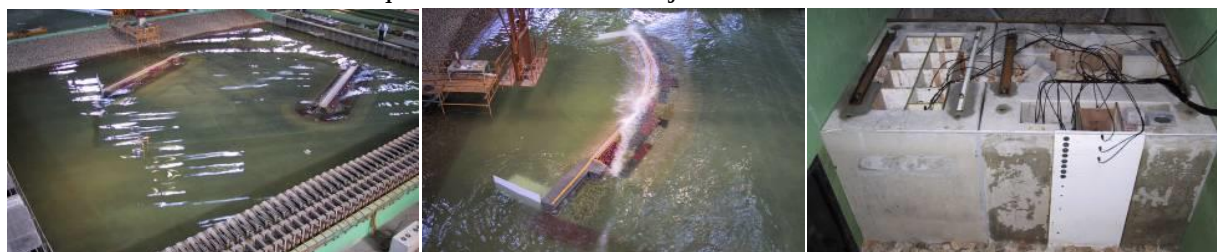
Figura 35. Ensayos: 3D Diques Este y Sur (E: 1/43) y fase constructiva Dique Este (E: 1/10).
