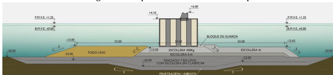
Figura 33. Dique Sur. Tramo 2. Sección tipo.
